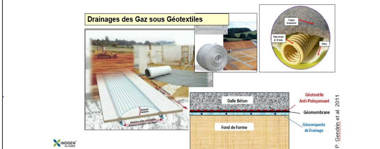
Fig. 24a-d : Dispositifs constructives de dépollution et de prévention possibles via des drainages des gaz (drainages conduites et drainages sous forme des tapis), Gendrin et al. 2011
